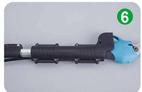
6. serrer les vis de fixation du boîtier et fixer le boîtier avec des ciseaux
