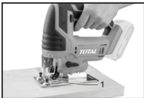
Para cortes internos sem um corte de entrada de uma borda, faça um furo inicial de 1/2" (12 mm) ou maior de diâmetro. Insira a lâmina neste furo para iniciar o corte.
