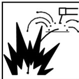
Le soudage peut provoquer des incendies ou des explosions. Le soudage dans des conteneurs fermés, tels que des réservoirs, des fûts ou des tuyaux, peut les faire exploser. Des étincelles peuvent sortir de l'arc de soudage. Les étincelles émises, la pièce à travailler chaude et l'équipement chaud peuvent provoquer des incendies et des brûlures.
