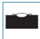
Vitesse d'avance trop élevée: provoque une pénétration insuffisante du matériau de base, une couture étroite et haute et de gros dépôts de scories qui peuvent être difficiles à éliminer.
