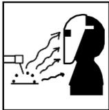
Les rayons de l'arc de soudage peuvent brûler les yeux et la peau. Les rayons d'arc du processus de soudage produisent des rayons visibles et invisibles intenses (ultraviolets et infrarouges) qui peuvent brûler les yeux et la peau. Les étincelles sortent de la soudure.
