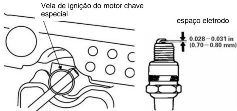
3) Verifique a vela de ignição. Substituir a vela de ignição, se o eléctrodo é danificado ou quebrada isolamento. O espaço entre a fásca eléctrodos é de 0,70 mm a 0,80 mm. Ajustar os eléctrodos laterais, se necessário.
