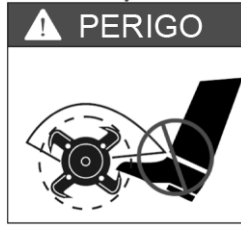
Etiqueta de identificação de risco por rotação de elementos cortantes
