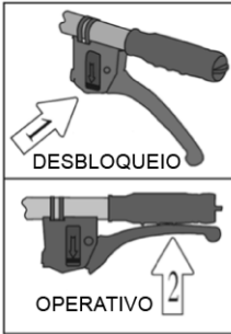
Etiqueta de identificação da posição de bloqueio e desbloqueio do guiador
