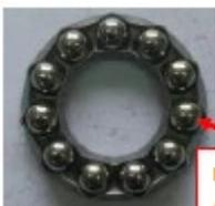
FIGURA 13 (Posizionare il telaio a sfere in acciaio come da foto)
