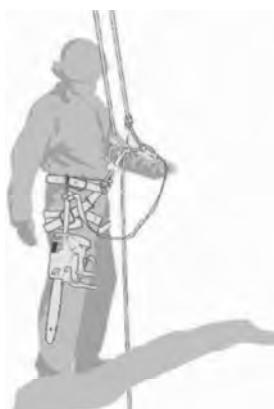
A1 — Exemple de connexion de la tronçonneuse au harnais pour grimper à un arbre
