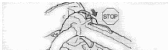
8. Retirer la bougie d'allumage et appliquer une demi-cuillère à soupe d'huile moteur deux temps propre sur le cylindre à travers l'insert de bougie.
