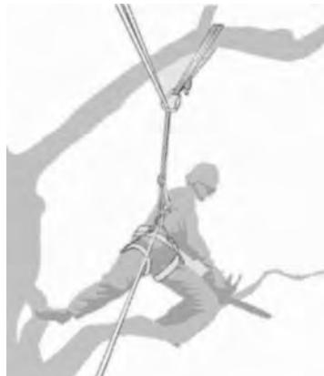
A.3 — Exemple de redirection de la corde principale via un point d'ancrage supplémentaire.
