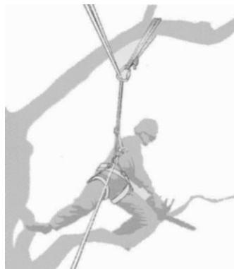
A.3 — Exemplo de redirecionamento do cabo principal através de um ponto de ancoragem suplementar
