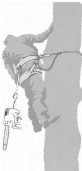
A.2 — Exemple d'ancrage dans la zone centrale arrière du harnais.
