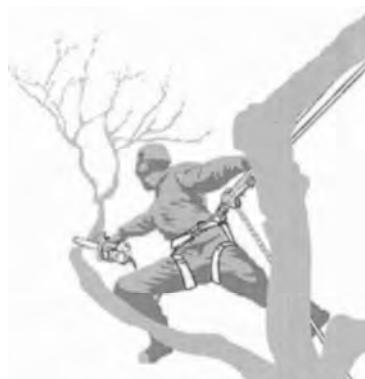
A.5 – Exemple d'utilisation de la tronçonneuse avec une main.
