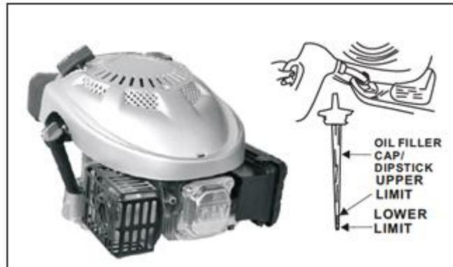
**⚠ ATENÇÃO:** A operação do motor com um baixo nível de óleo pode causar danos no motor. Reinstalar o enchimento de óleo tampa / vareta com segurança.
