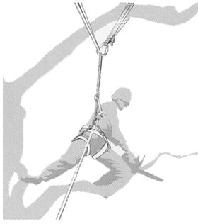
Figura 3: Exemplo de redirecionamento da linha principal através de um ponto de ancoragem suplementar.
