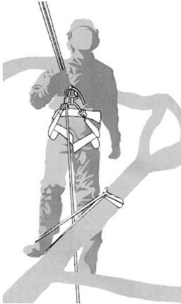
Figure 4 : Exemple d'étrier de pied temporaire créé à partir d'une élingue sans fin
