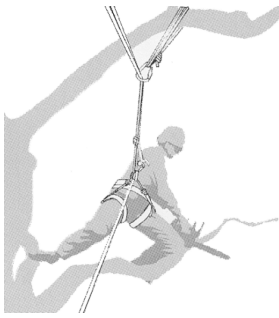
Figure 3 : Exemple de redirection de la ligne principale via un point d'ancrage supplémentaire.
