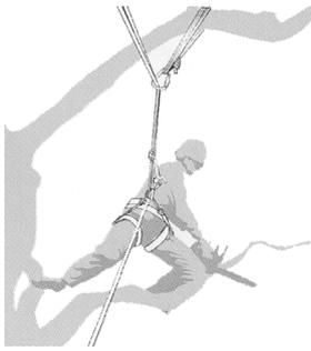
Sin embargo, a medida que los operadores se alejen del vástago, deberán tomar medidas para eliminar o contrarrestar las crecientes fuerzas laterales mediante, por ejemplo, una redirección de la línea principal a través de un punto de anclaje suplementario o el uso de una correa ajustable directamente desde el arnés. a un punto de anclaje suplementario.
