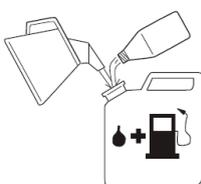
Los motores están lubricados por aceite especialmente formulado para el uso de motores de gasolina de 2 tiempos refrigerados por aire. Si el aceite no está disponible, utilice un aceite de calidad con antioxidante agregado expresamente etiquetado para el uso del motor de 2 tiempos refrigerado por aire.
