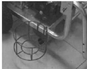
**Figure 5 - Fixez le support du récipient pour une bouteille de détergent**
