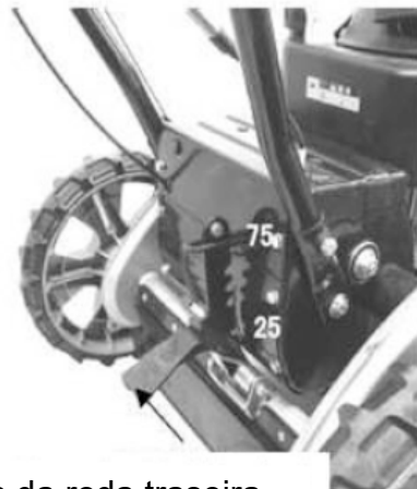
Ajuste de altura da roda traseira
