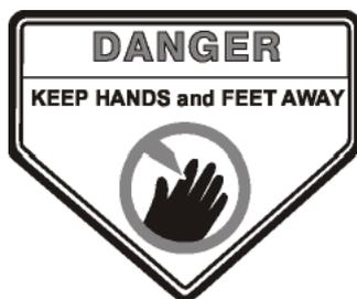
Figura B: etiqueta de segurança encontrado na cortador: Mãos e pés continuam ALEJADOS. Advertencia: Mantenha segurança sinais claros e visíveis no computador. Substituir sinais de segurança se em falta ou ilegível.
