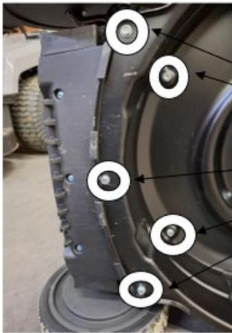
Sostituire queste 5 viti cilindriche in plastica con 5 viti cilindriche in acciaio inossidabile da 6,3 x 25 mm con rondelle. Queste viti fissano il supporto dell'asse anteriore al telaio della macchina.
