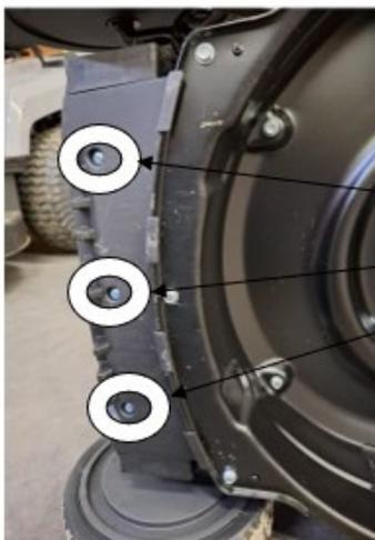
Sostituire anche le 3 viti a testa svasata in plastica del rivestimento anteriore con 3 viti a testa svasata in lamiera di acciaio inossidabile 4,2 x 25 mm senza rondella.
