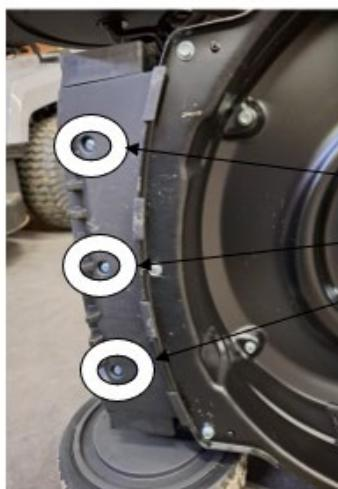
Ersetzen Sie auch die 3 Senkkopfschrauben aus Kunststoff der vorderen Verkleidung durch 3 Senkkopfschrauben aus Edelstahlblech 4,2 x 25 mm ohne Unterlegscheibe.
