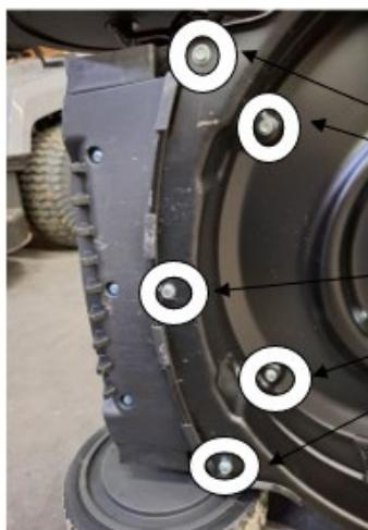
Ersetzen Sie diese 5 Zylinderschrauben aus Kunststoff durch 5 Zylinderschrauben aus Edelstahl 6,3 x 25 mm mit Unterlegscheiben. Diese Schrauben befestigen die Halterung der Vorderachse am Maschinenrahmen.
