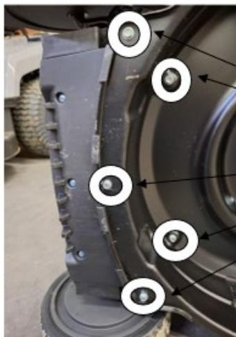
Remplacer ces 5 vis à tête cylindrique en plastique par 5 vis à tête cylindrique en acier inoxydable de 6,3 x 25 mm avec rondelles.
