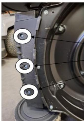
Remplacer également les 3 vis à tête fraîsée en plastique de la garniture avant par 3 vis à tête fraîsée en tôle INOX de 4,2 x 25 mm sans rondelle.
