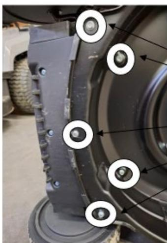
Substitua estes 5 parafusos de rosca de plástico por 5 parafusos de rosca de chapa INOX de 6,3x25 mm com anilhas.
