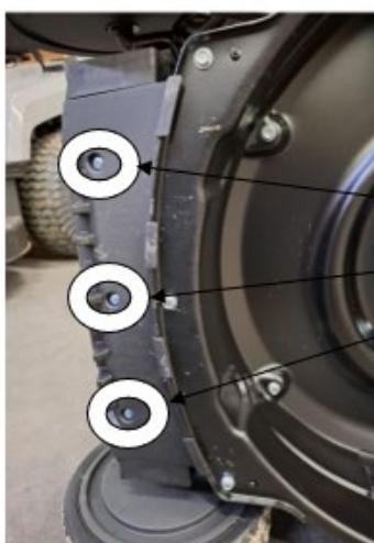
Substitua também os 3 parafusos de rosca de plástico do embelezador frontal por 3 parafusos de rosca de chapa INOX de 4,2x25 mm sem arruela
