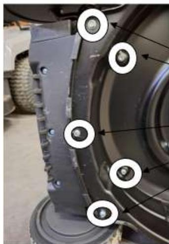
Sustituir estos 5 tornillos de rosca de plástico por 5 tornillos de rosca de chapa INOX de 6,3 x 25 mm con arandelas.
