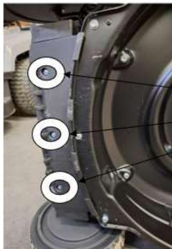
Sustituir también los 3 tornillos de rosca de plástico del embellecedor frontal por 3 tornillos de rosca de chapa INOX de 4,2 x 25 mm sin arandela.
