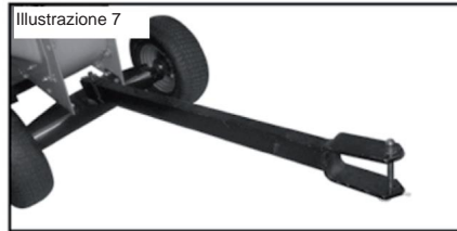
Figura 7. Fissaggio dell'asta di traino
