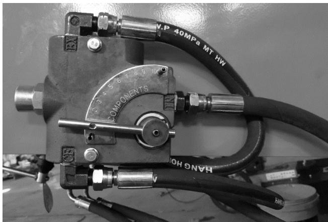
Über die Leiste lässt sich die Rotationsgeschwindigkeit der Vorschubwalze einstellen (von 0 bis 600 U/min).
