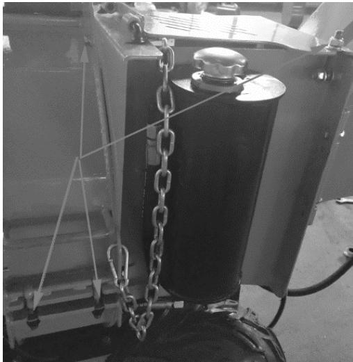
Durch Lösen dieser 4 Schrauben können Sie die Kammer öffnen, um den Zustand der Flügel und Lüfter zu überprüfen.
