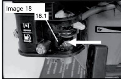
Une fois le moteur arrêté, et avant de ranger la machine, amenez le levier de carburant en position « OFF », comme illustré sur l'Image 18 (18.1).
