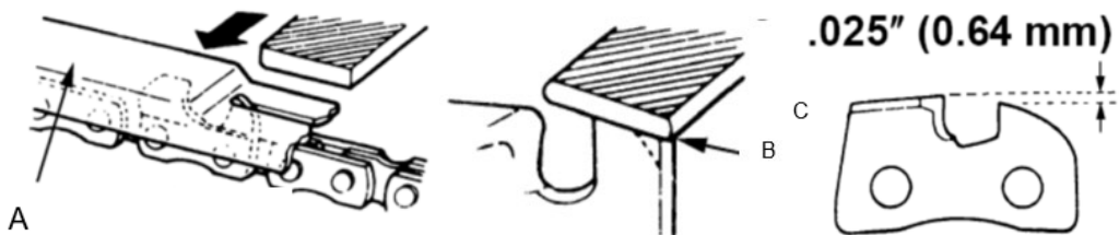
A. Controllo dell'altezza B. Deposito della protezione dell'ingresso circolare C. Profondità di ingresso nel taglio standard
