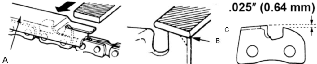
A. Verificador de altura B. Arquivamento da proteção de entrada redonda C. Profundidade de entrada no corte padrão
