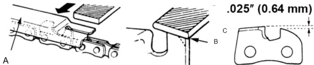
A. Comprobador de altura B. Limado de la protección de entrada en redondo C. Profundidad de entrada en corte estándar
