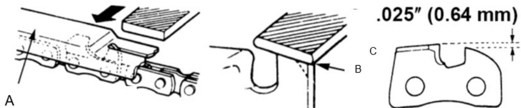
A. Vérificateur de hauteur B. Dépôt de la protection entrée ronde C. Profondeur d'entrée en coupe standard
